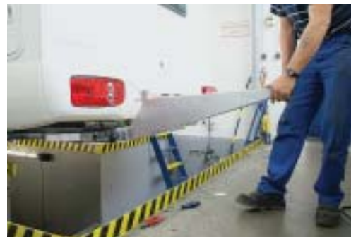
Am verlängerten Rahmen lassen sich eine Anhängerkupplung oder, wie hier zu sehen, die Halter eines Motorradheckträgers montieren.
